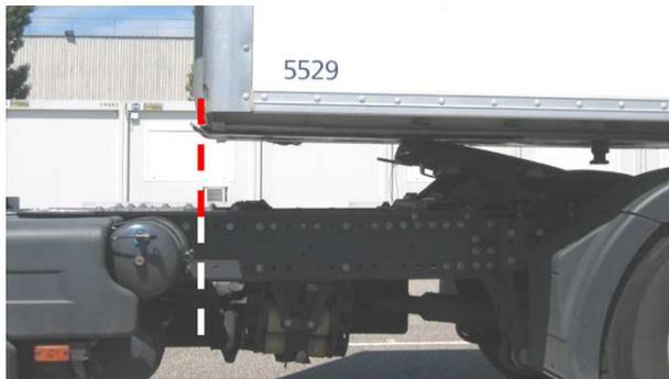
Je recule **doucement** et **j'arrête** le tracteur au moment où l'**aplomb** avant de la semi-remorque (ou feux de gabarit avant gauche) **se situe avant les réservoirs d'air** du tracteur
