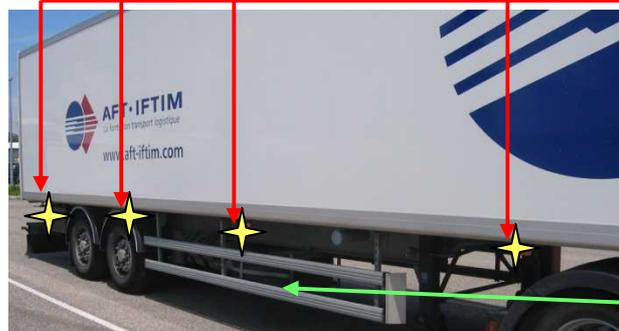
Je contrôle avec la main la fixation de la barre latérale de protection
