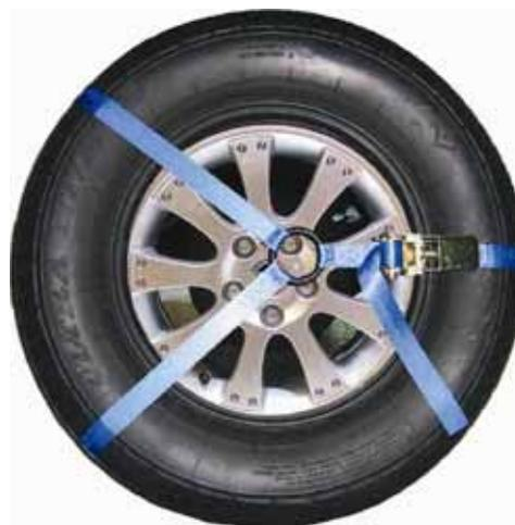
Sangle permettant le maintien de la roue de secours.
