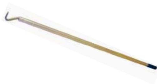
En acier, cette baguette permet de déverrouiller les poutres stockées en position haute du rail
