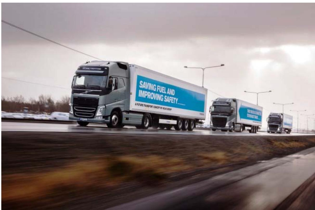
Du reste, le système de MAN fonctionne avec une liaison WLAN entre camions. Les véhicules roulent ainsi à 10 mètres les uns des autres. Le camion de tête informe les autres des conditions de circulations et de l'éventuel relief. Le constructeur ne communique pas sur les gains de consommation attendus. Par contre, si la technologie du « truck platooning » obtient un feu vert de l'UE, il estime être prêt à l'implanter en 2020.
